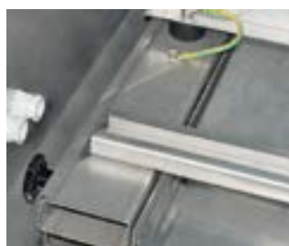
Komponenter kan dras ut via utdragbara glidskenor
