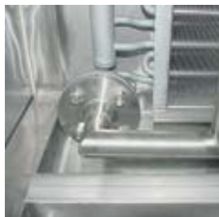
Aggregatinsidan är uppbyggd i en helsvetsad kammare
